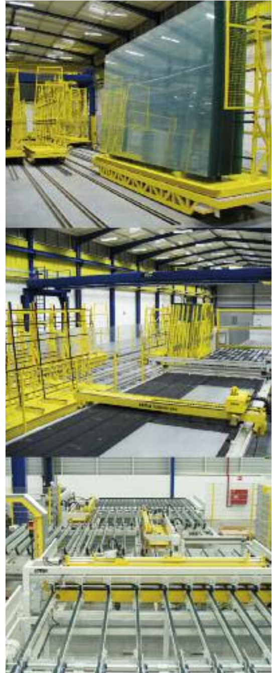
HEGLA-Hochleistungsschneidlinie mit Shuttle-Beschickungssystem, Modellschneidanlage OPTIMAX Plus sowie X/Y Brechanlage
