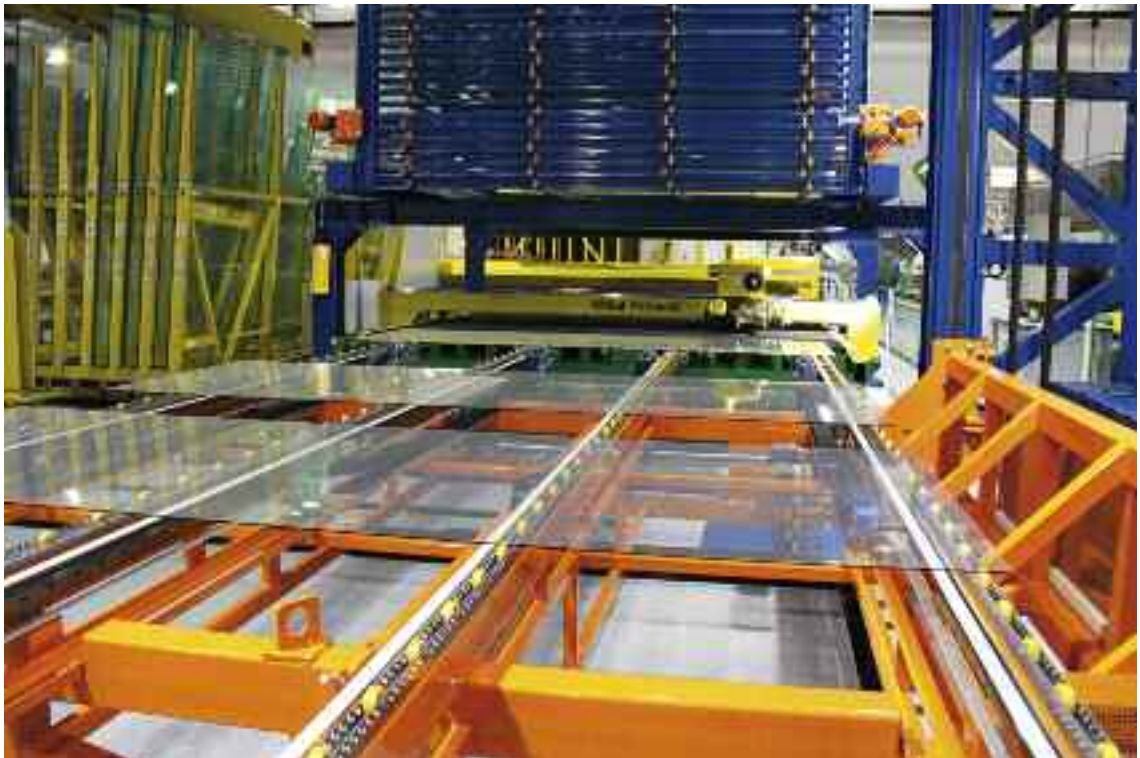
ReMaster mit Mehrfachbeladung von HEGLA in Verbindung mit ProLam-Schneidanlage für Verbundsicherheitsglas
