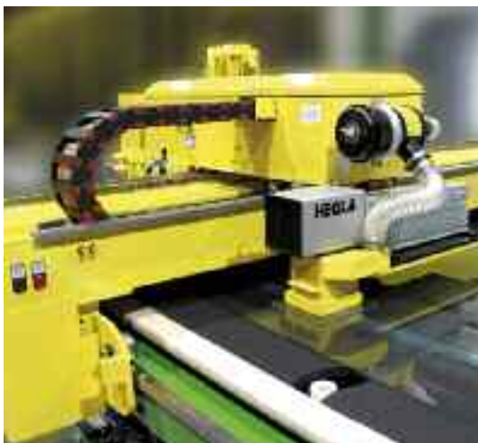
Lasermarkierung zur einfachen und dauerhaften Kennzeichnung von Glasscheiben
