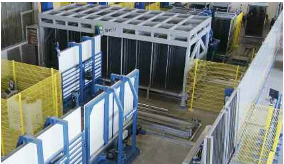
SortJet zur Online-Produktion - direkt vom Glaszuschnitt auf die Isolierglas-/Bearbeitungslinien
