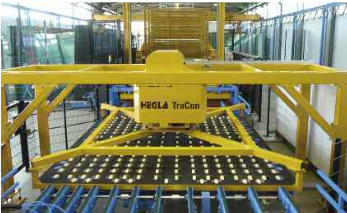
HEGLA-Schneidlinie mit Tandem-ReMaster und Traveren-Drehvorrichtung TraCon zur automatischen 90°-Drehung der Glasscheiben
