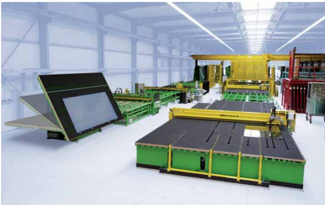
Effizienter Float- und VSG-Zuschnitt mit dem Re-Master von HEGLA
