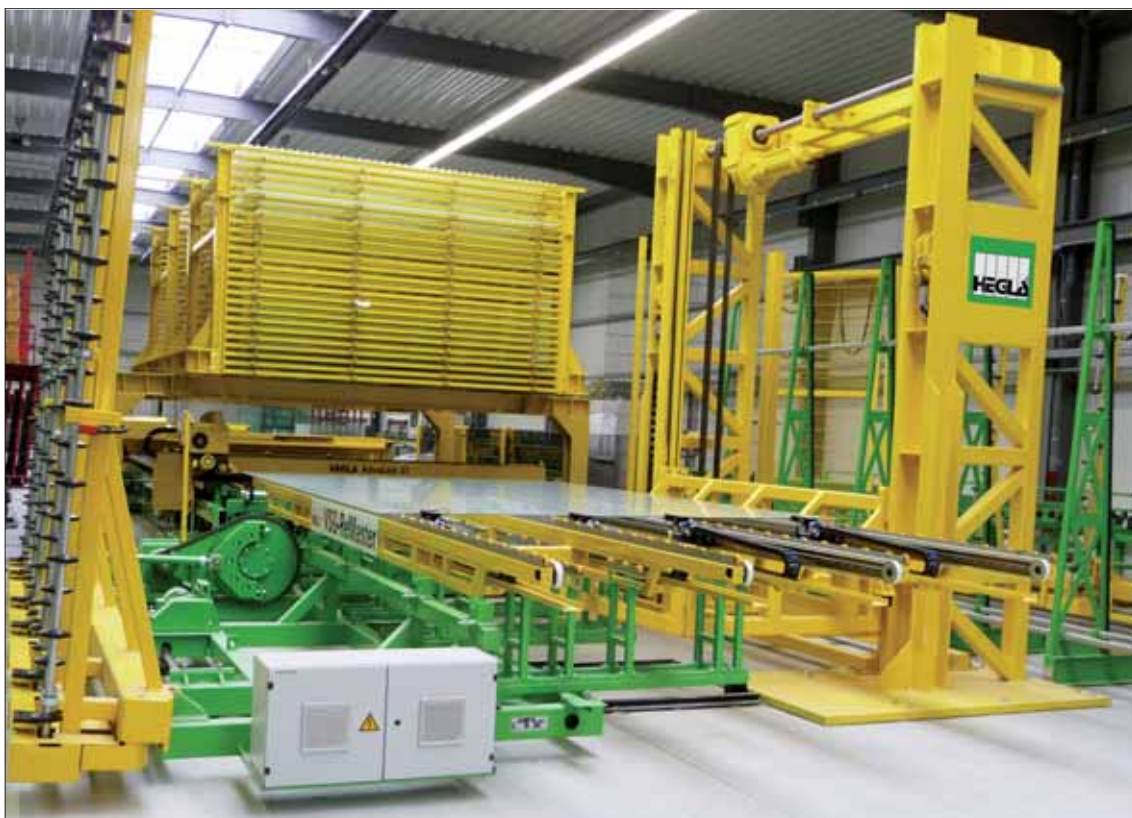
Der VSG-ReMaster – Die effiziente Lösung zur Zwischenlagerung von VSG-Resttafeln
